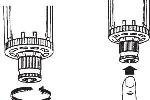
Wasser aus dem Wasserabscheider ablassen
