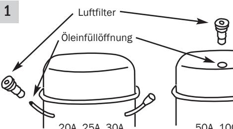
Öl einfüllen/Luftfilter einstecken
