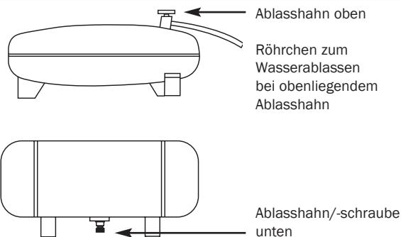
Kondenswasser aus dem Tank ablassen
